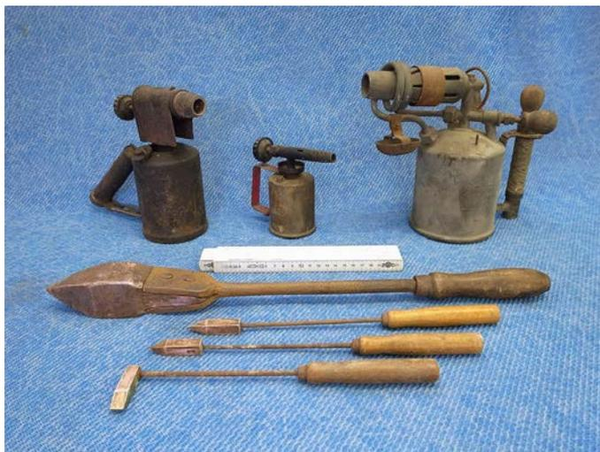
газовый и медный. Последний, разогревался с помощью всё того же газа, или в печи.
