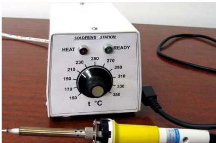
Это позволяет не перегревать элементы **электроники**. В лабораториях и промышленности получили распространение паяльные станции.
