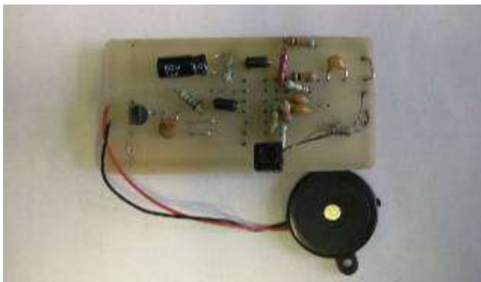
Рисунок 15 – Монтаж радиоэлементов на печатную плату.
