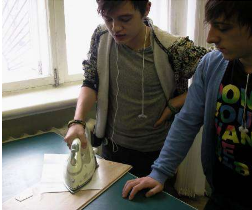
Рисунок 10 – Перенос рисунка на плату.
