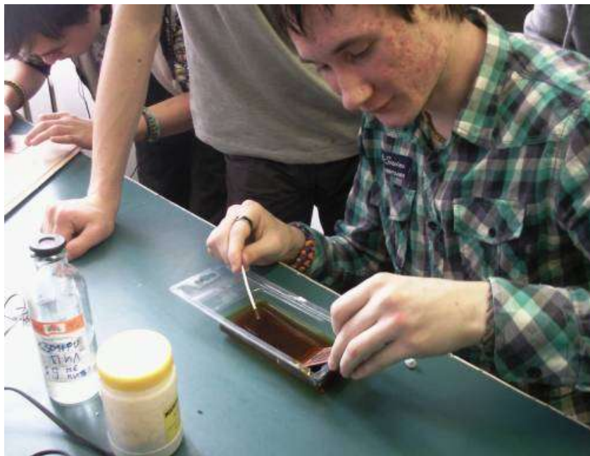
Рисунок 12 – Вытравливание платы в растворе хлорного железа.
