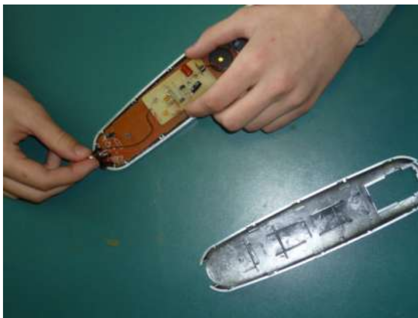
Рисунок 16 – Монтаж устройства в пульт дистанционного управления
